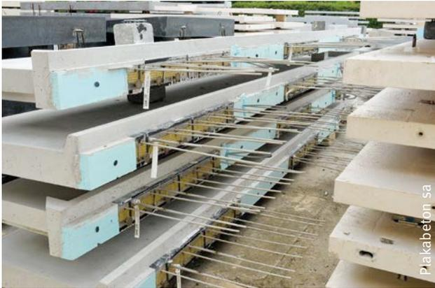
Fig. 79 Balcons préfabriqués intégrant un rupteur thermique.
